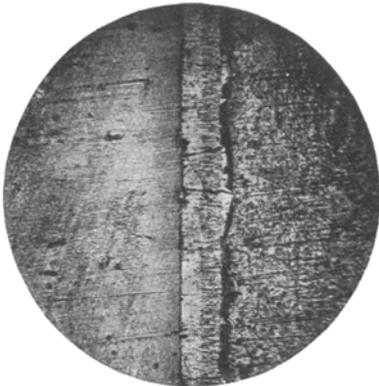
Fig. 3. Armco-Eisen, 1 Stunde bei  $445^\circ$  verzinkt. 125 fach vergrößert.
