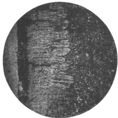
Fig. 4. Armco-Eisen, 1 Stunde bei  $485^\circ$  verzinkt. 125 fach vergrößert.
