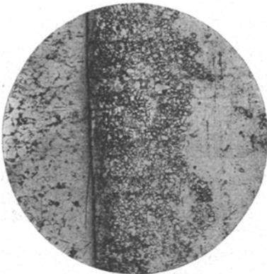
Fig. 14. Stahl I mit 0·09 % C, 1 Stunde bei 500° verzinkt. 125fach vergrößert.
